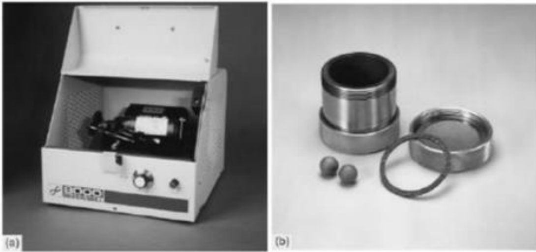
Şekil 3.11. Spex tipi öğütücü, (a)spex bilyalı değirmen, (b) spex 8000 tipi karıştırıcının; öğütme kabı, kapak, conta ve bilyelerden oluşan öğütme seti (Nazik 2013)
