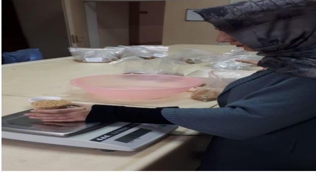
Şekil 13. Hektolitre Ağırlığının Tespiti
