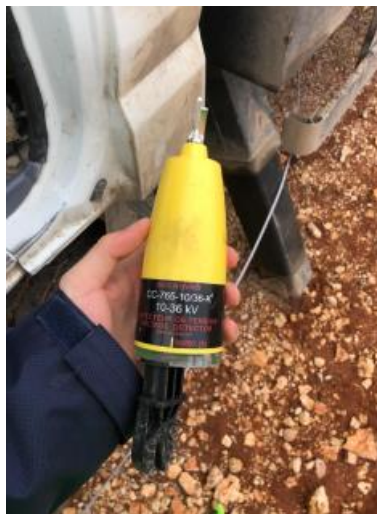
Şekil 2.13. Yüksek gerilim (YG) enerji kontrol dedektörü
