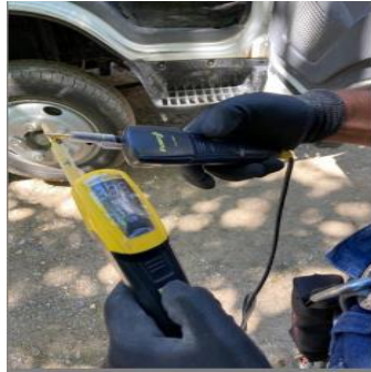
Şekil 2.12. Alçak gerilim (AG) enerji kontrol dedektörü
