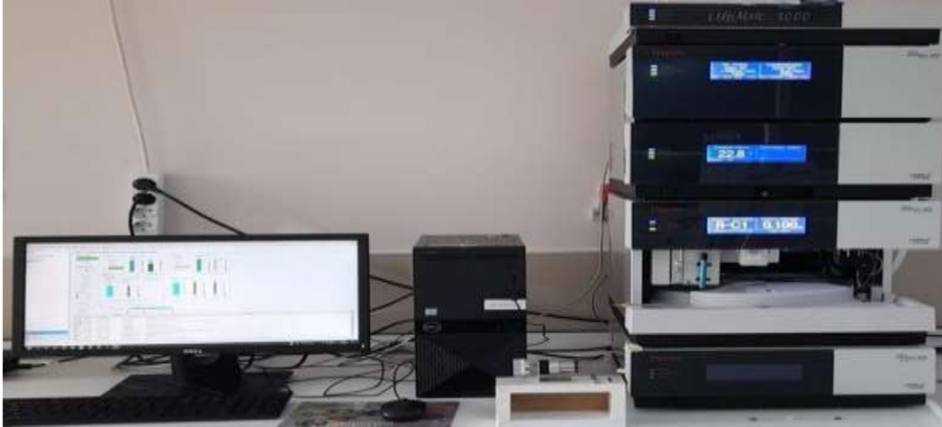
Şekil 2.2. Tez çalışması kapsamında kullanılan Nano-LC sistemi
