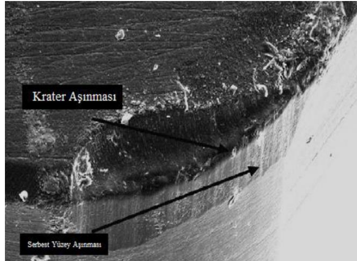
Şekil 4.15. Krater aşınması [75]
