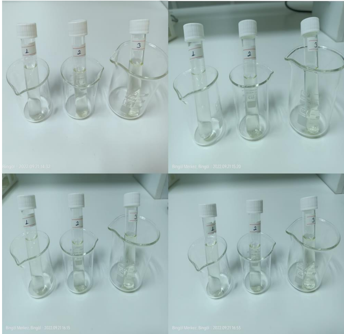
Şekil 4.8. Farklı solvent sistemleriyle saatlik 100 ppm KoQ10 çöktürme denemeleri: 1) ACN:2-PrOH (2:1 v/v); 2) MeOH:2-PrOH (2:1 v/v) 3) EtOH:2-PrOH (2:1 v/v)
