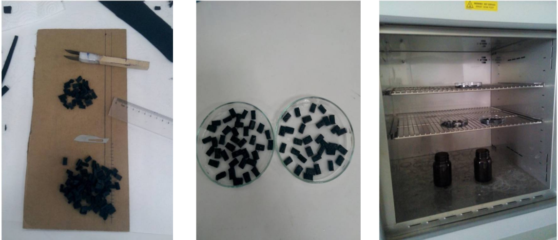
Şekil 3.2. Elektrotların hazırlanma aşamaları sırasıyla karbon keçenin kesilmesi, yıkanarak petri kabına dizilimi ve etüvde kurutulması görüntüleri
