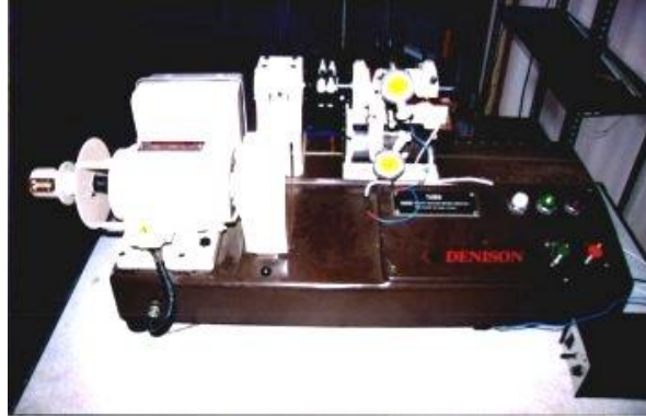
Şekil 3.15. Samuel Denison Ltd. yorulma test cihazı
