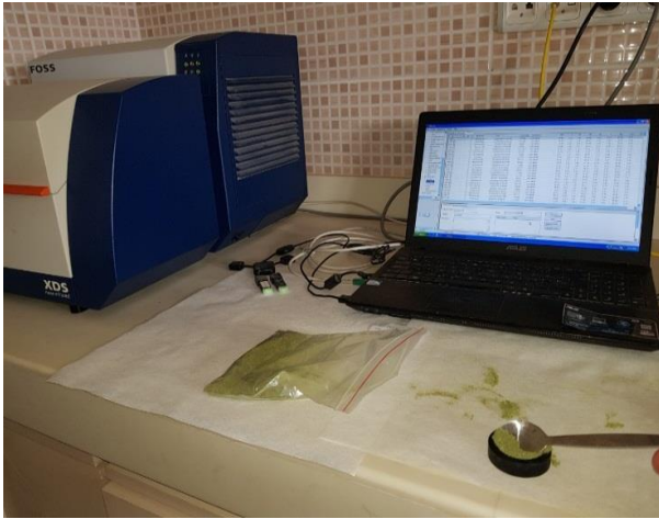
Şekil 3.5. NIRS cihazı ile kalite özelliklerinin belirlenmesi
