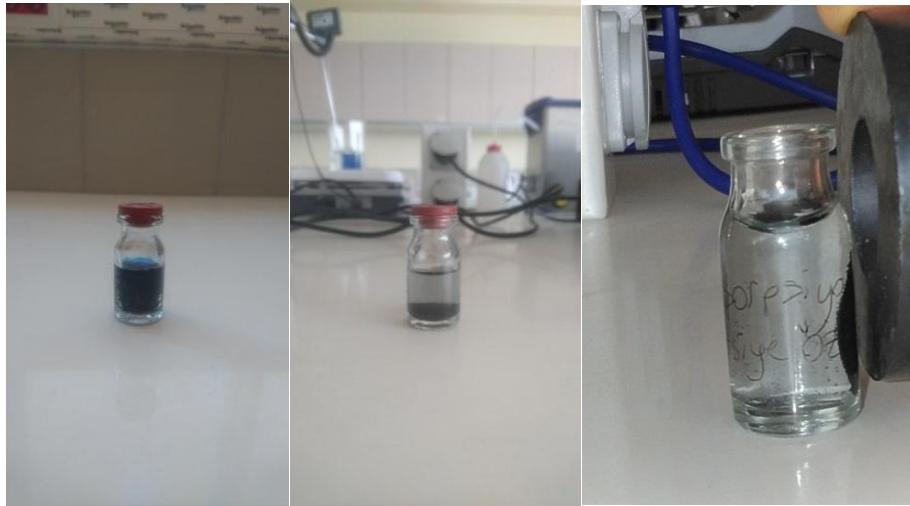
Şekil 4.3.(a) Boyar maddeye aktif karbon ilavesi (b) aktif karbonun boyar maddeyi adsorplaması (c) Miknatıs ile adsorbanın uzaklaştırılması
