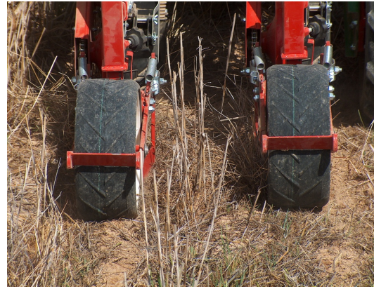
Şekil 2. Denemelerde buğday dışında kalan bitkilerin ekiminde kullanılan pünomatik doğrudan ekim makinesi
