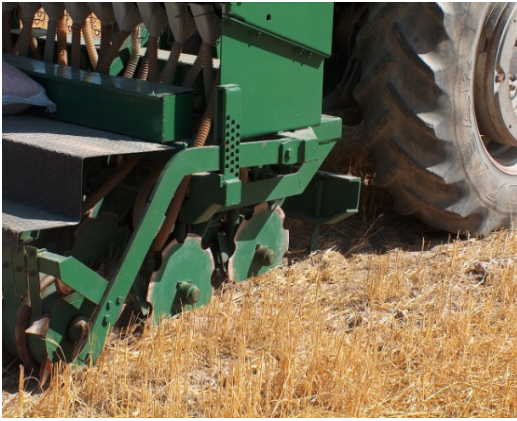
Şekil 1. Bahri Dağdaş UTAE ve Özdöken A.Ş. tarafından tahıl ekimleri için geliştirilen doğrudan ekim makinesi
