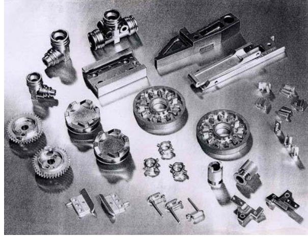
Şekil 2.2. Toz enjeksiyon kalıplama yöntemi ile üretilmiş çeşitli parçalar (Kryachek 2004)
