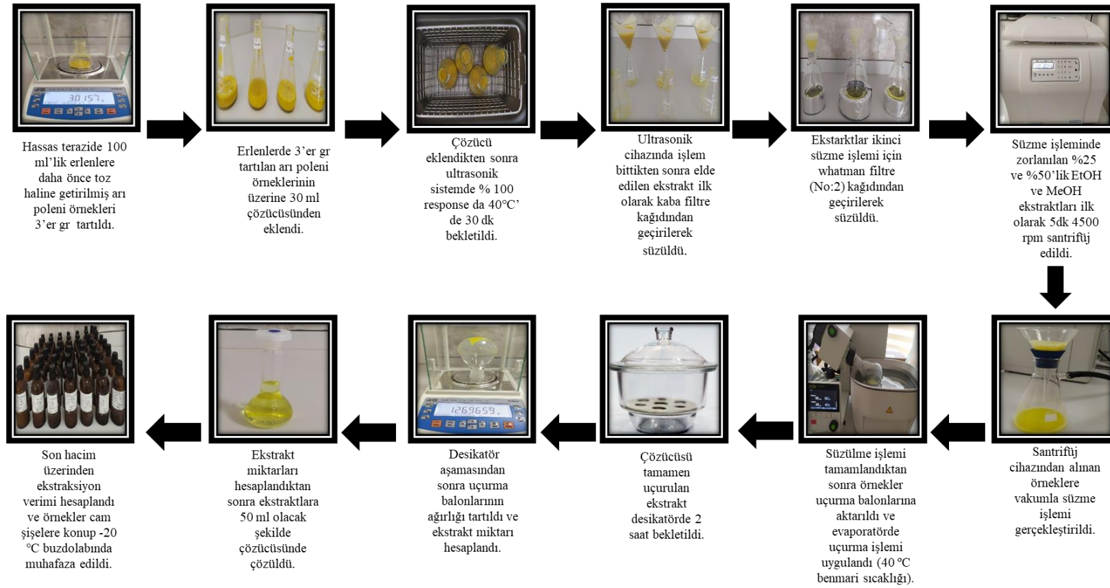
Şekil 3.4. Ekstraksiyon işleminin aşamalarını gösteren diyagram
