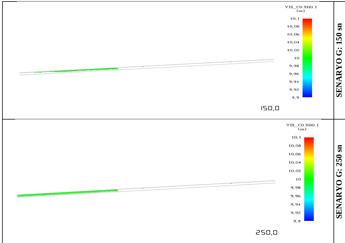
Şekil 4.32. S-G'nin belli saniyelerdeki tünel boyunca duman görünürlükleri
