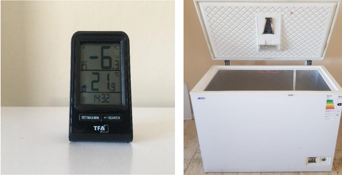
Şekil 3. 5. Çalışmada iç (derin dondurucu) ve dış (oda/laboratuvar iç sıcaklık) sıcaklığın takibi için kullanılan dijital termometre
