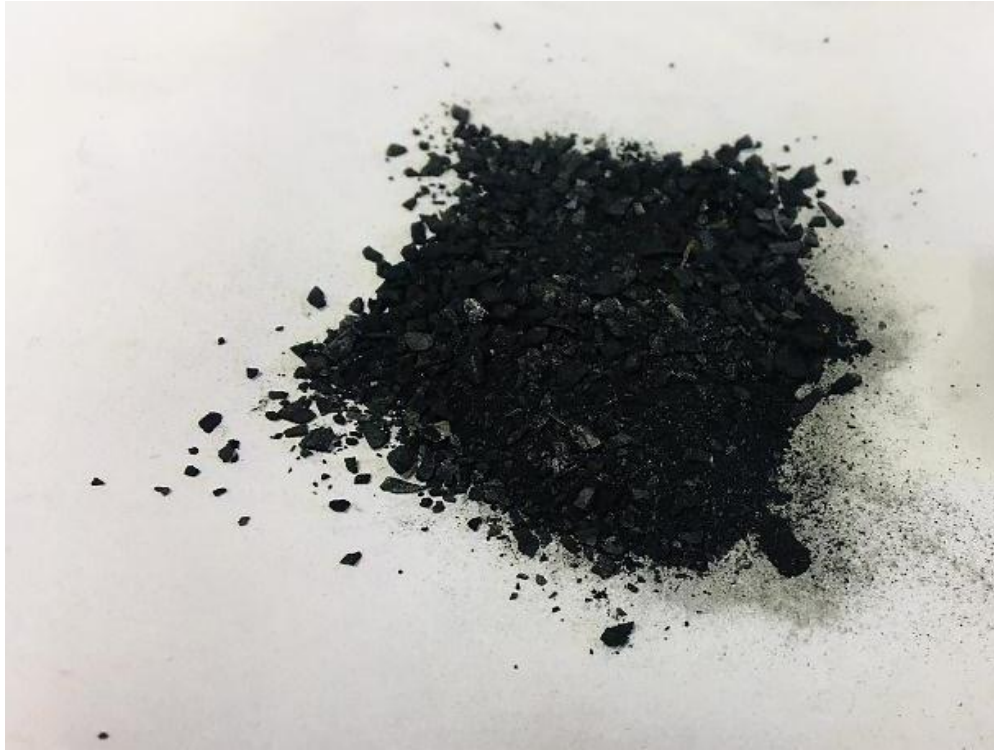
Şekil 3. 2. Çalışmada kullanılan biyokömür (Ceviz kabuğunun kül fırınında yakılması sonrası) materyali
