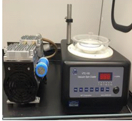
Şekil 3.7. Döndürmeli Kaplayıcı - VTC-100 Vacuum Spin Coater
