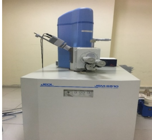
Şekil 3.9. Taramalı Elektron Mikroskop (SEM) JEOL JSM 6510
