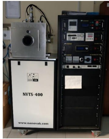
Şekil 3.6. İnce Film Kaplama Sistemi, NANOVAK NVTS-400
