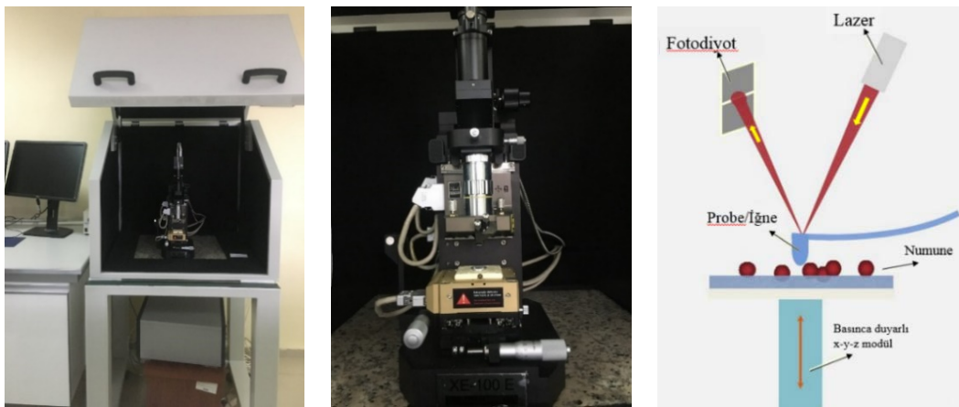
Şekil 3.11. Atomik Kuvvet Mikroskobu (AFM) Park Systems XE-100E ve 2D Temsili Görseli
