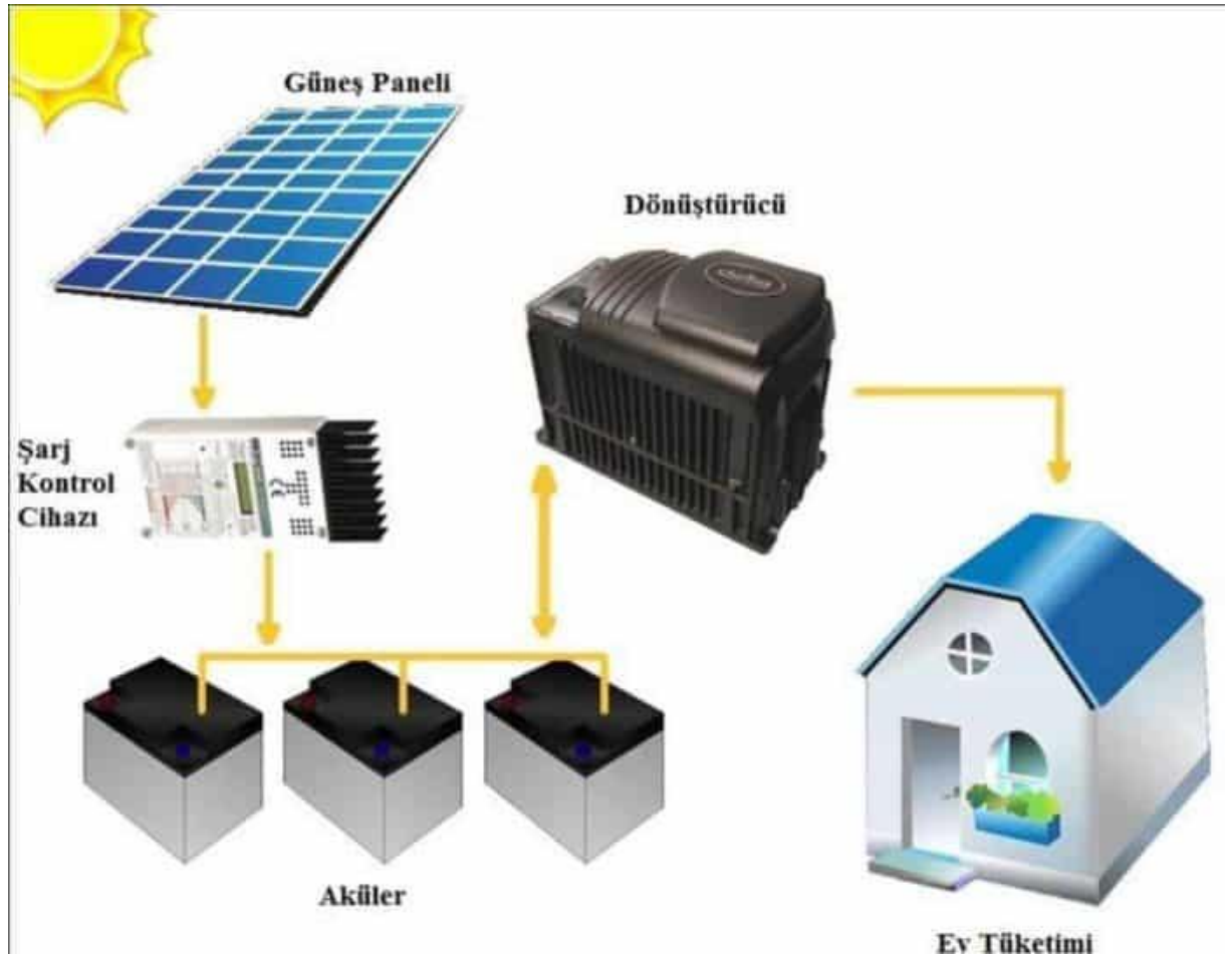
Şekil 2.23. Şebekeden bağımsız (stand alone ya da off-grid) sistem uygulaması
