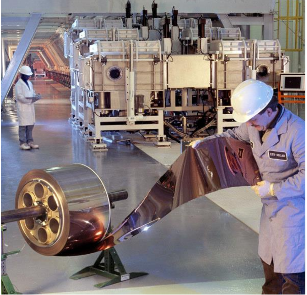
Şekil 2.15. Rulo halinde güneş pili
