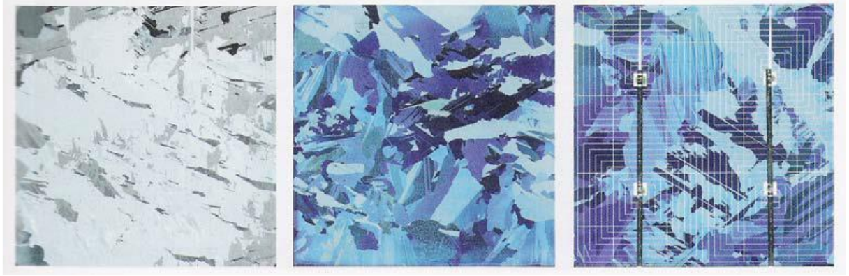
Şekil 2.11. Çok kristalli silikon güneş pilleri
