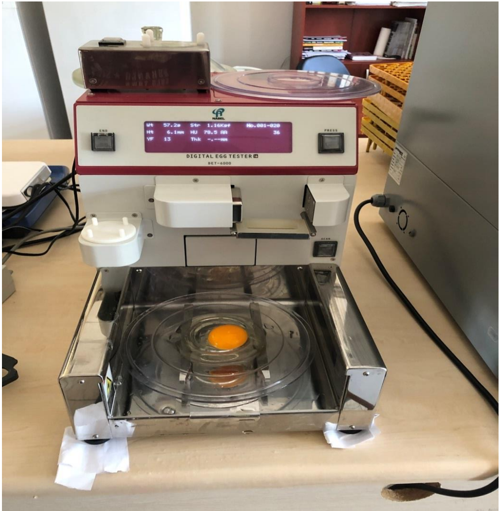
Şekil 7. Yumurtaların kalite ölçümlerinde kullanılan Digital Egg Tester cihazı
