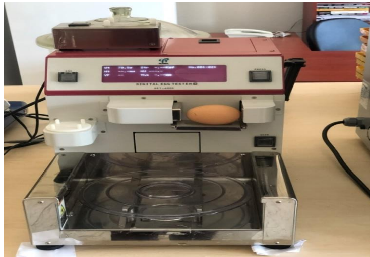
Şekil 8. Yumurtaların kırılma direncinin Digital Egg Tester cihazı ile ölçülmesi
