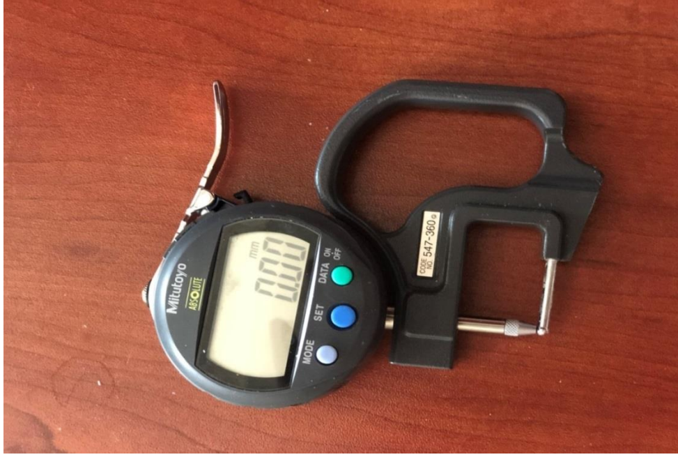
Şekil 4. Yumurtaların kabuk kalınlığının ölçümünde kullanılan dijital kalınlık ölçme aleti.
