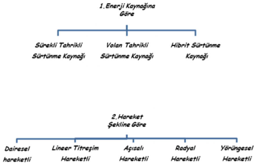
Şekil 3.6. Sürtünme kaynağının sınıflandırılması (Kırık ve Özdemir 2012)
