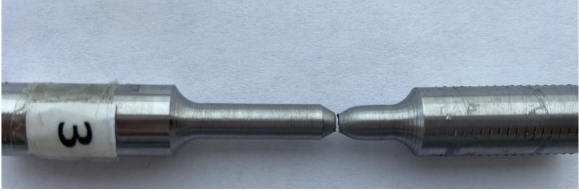
Şekil 5.43. S3 no'lu numunenin çekme deneyi sonrası fotoğrafı
