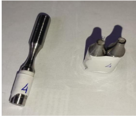
Şekil 5.55. S4 numaralı numunelerin yorulma deneyi fotoğrafı
