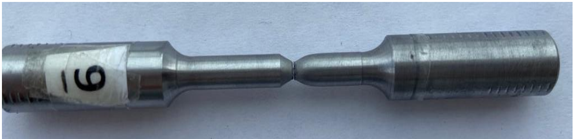
Şekil 5.47. S9 no'lu numunenin çekme deneyi sonrası fotoğrafı
