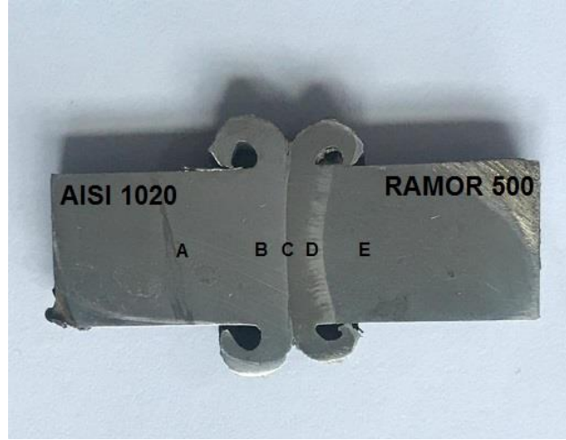
Şekil 5.12. 2200 devir sayısı (dev/dak) kullanılarak birleştirilen S9 numunesinin mikroyapı fotoğrafı
