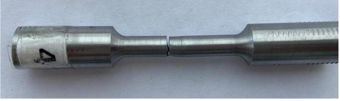
Şekil 5.49. S4 no'lu numunenin çekme deneyi sonrası fotoğrafı
