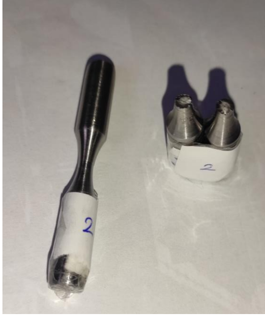
Şekil 5.53. S2 numaralı numunelerin yorulma deneyi fotoğrafı
