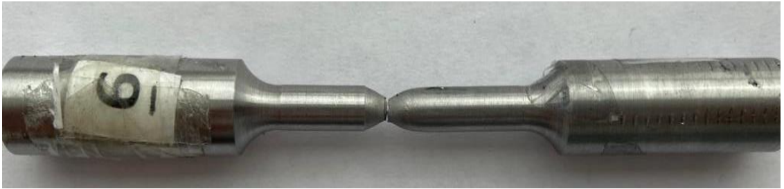
Şekil 5.51. S6 no'lu numunenin çekme deneyi sonrası fotoğrafı
