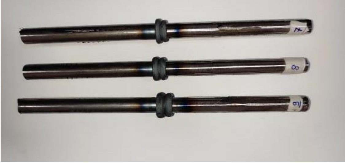
Şekil 5. 3. S7, S8 ve S9 no' lu numunelerin makroskopik incelenmesi
