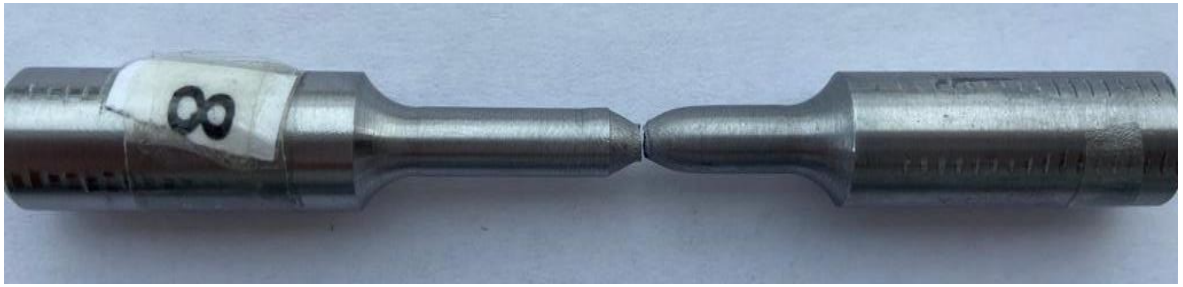
Şekil 5.46. S8 no'lu numunenin çekme deneyi sonrası fotoğrafı
