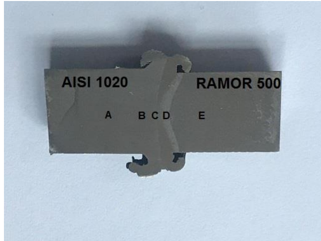
Şekil 5.18. 1800 devir sayısı (dev/dak) kullanılarak birleştirilen S5 numunesinin mikroyapı fotoğrafı
