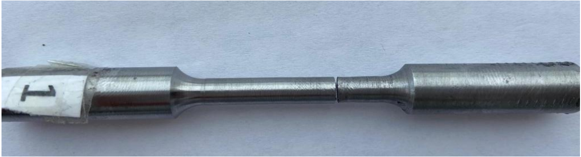
Şekil 5.41. S1 no'lu numunenin çekme deneyi sonrası fotoğrafı
