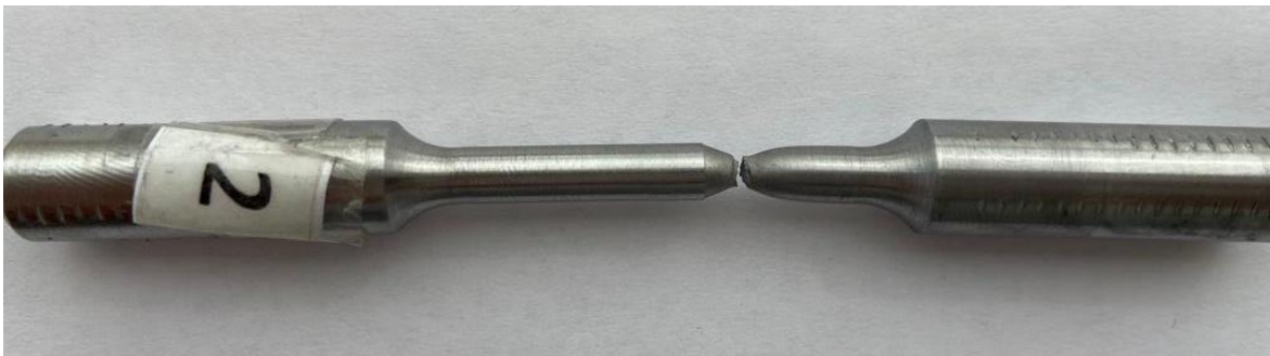
Şekil 5.42. S2 no'lu numunenin çekme deneyi sonrası fotoğrafı
