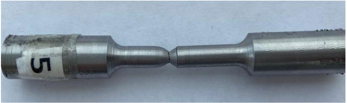
Şekil 5.50. S5 no'lu numunenin çekme deneyi sonrası fotoğrafı
