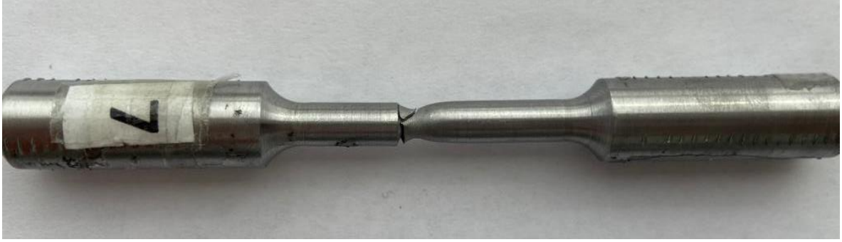
Şekil 5.45. S7 no'lu numunenin çekme deneyi sonrası fotoğrafı
