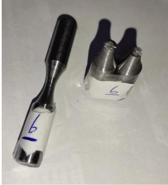
Şekil 5.54. S6 numaralı numunelerin yorulma deneyi fotoğrafı
