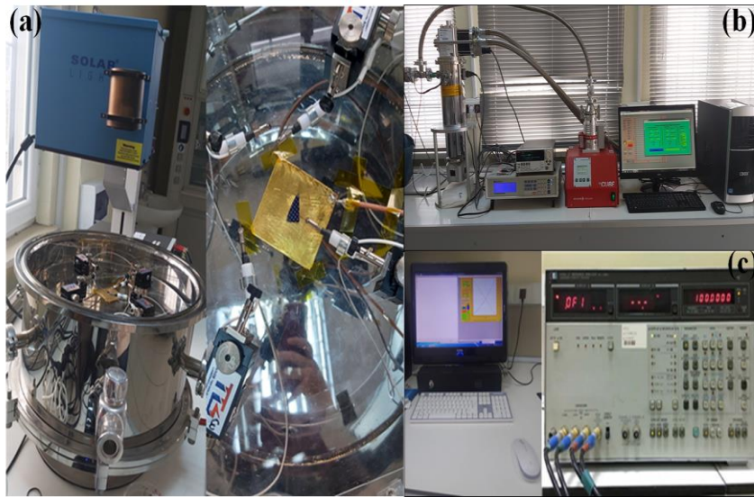
Şekil 3.7. (a) Akım-Gerilim Solar Simülatorü / Probe Station, (b) Kryostat cihazı-turbo vakum pompası, Keithley 2400, Güç kaynağı ve sıcaklık kontrol ünitesi, (c) Empedans Analiz Cihazı 4192A Model YHP Marka LF 5 Hz - 13 MHz
