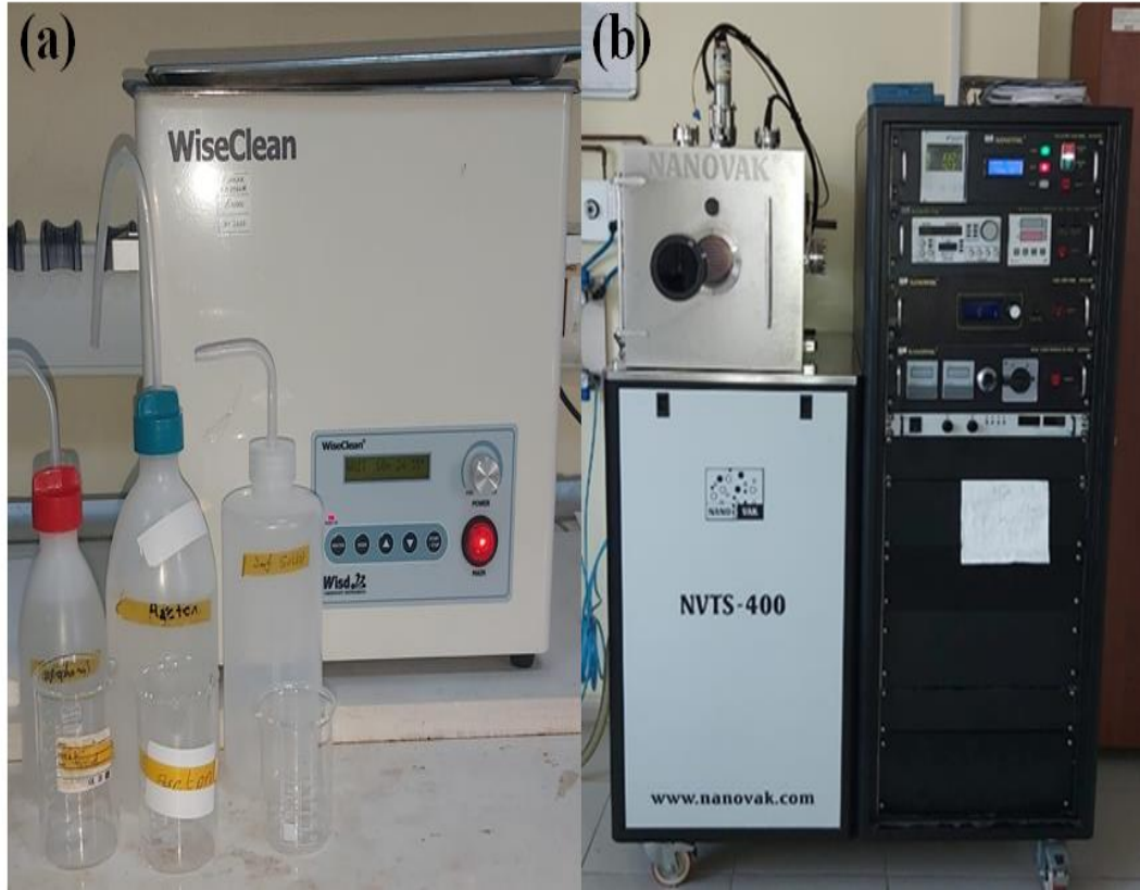
Şekil 3.4. (a) Ultrasonik Temizleyici, WiseClean, (b) Termal Buharlaştırma ve İnce Film Kaplama Sistemi, NANOVAK NVTS-400
