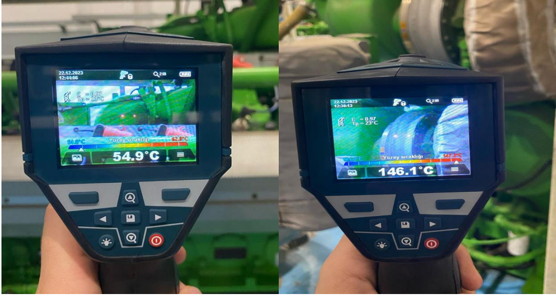
Şekil 6.43. Yakıtın motora giriş sıcaklığı ve turboşarj çıkış sıcaklığı
