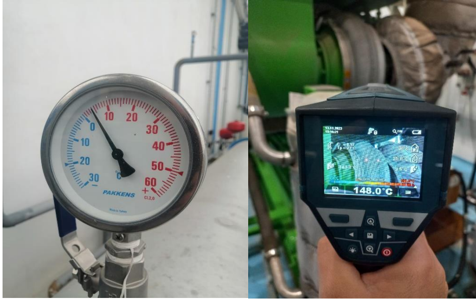
Şekil 6.2. Termometre ve kızılötesi termometre
