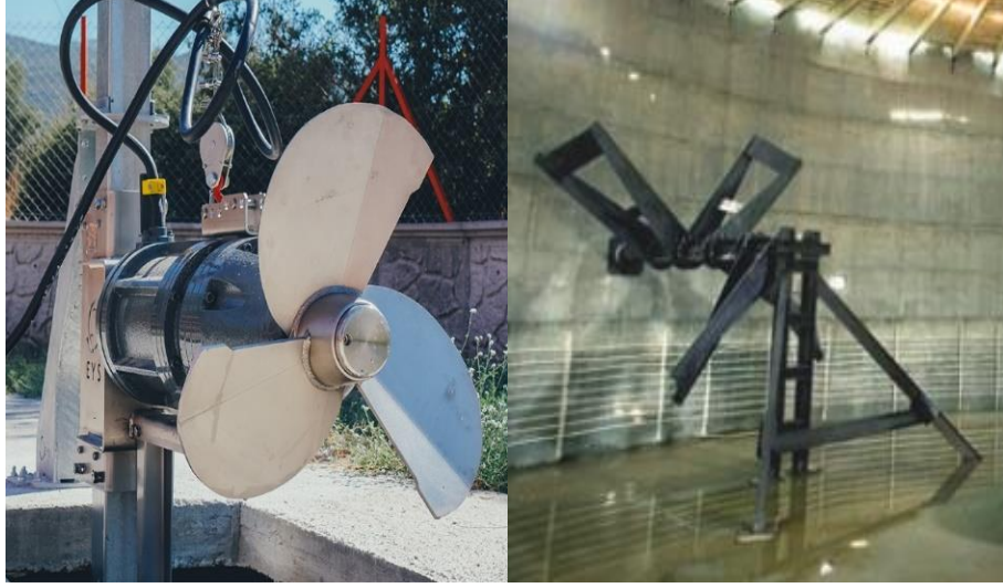
Şekil 6.6. Dalgıç motorlu ve paletli karıştırıcılar
