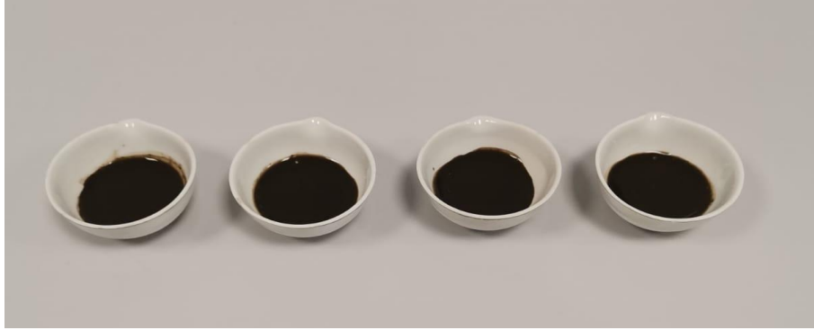
Şekil 6.22. KM-OKM test numuneleri soldan sağa ( sıvı süt sığırı gübresi, çürütücü atığı, post çürütücü atığı, seperatör sonrası sıvı )
