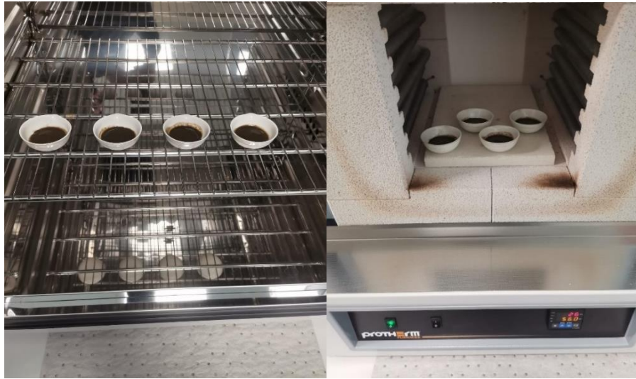
Şekil 6.23. Etüv ve kül fırınında numunelerin hazırlanma
