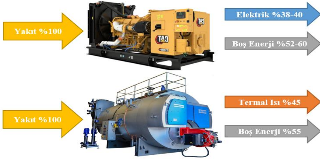
Şekil 4.8. Elektrik ve ısı enerjisi ayrı üretimi
