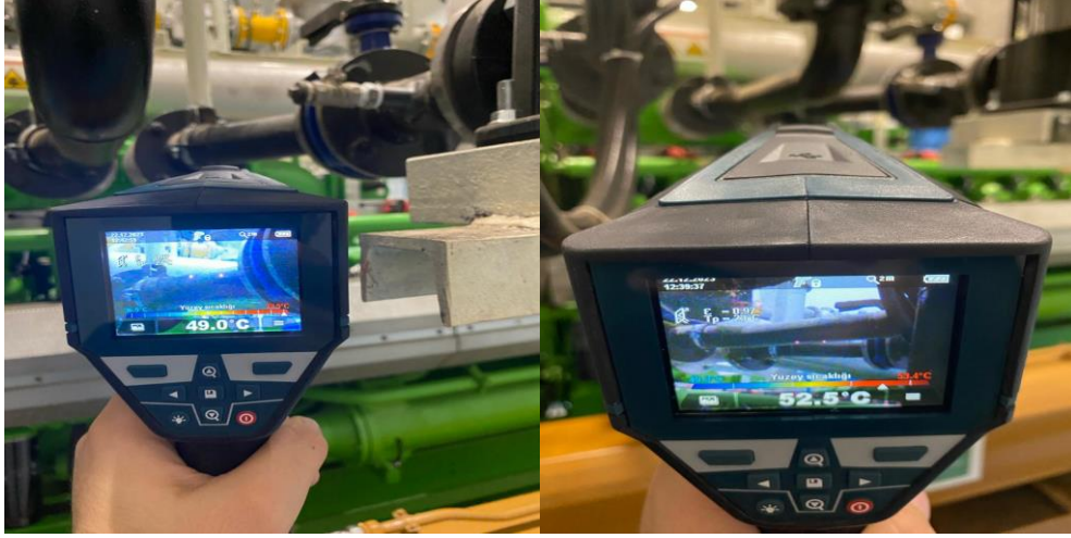
Şekil 6.45. LT devresi İntercooler giriş ve çıkış sıcaklığı
