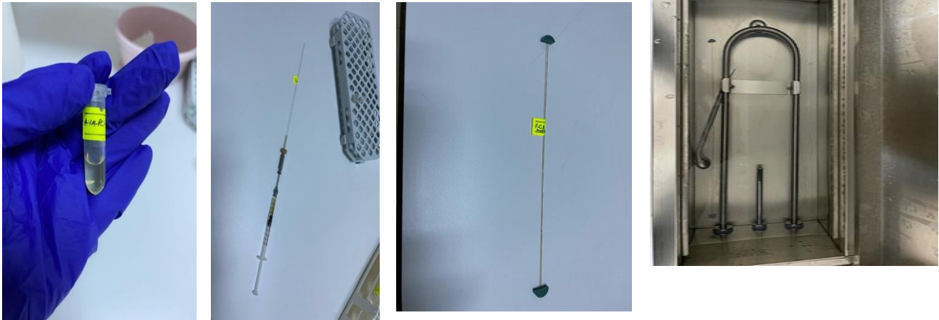
Şekil 4.2. 100 \mu\text{m} iç çaplı 30 cm NMM monolitik kolon sentez aşamaları
