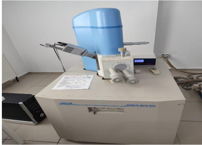
Şekil 3.15. SEM görüntüleme analizi ve deney cihazı
