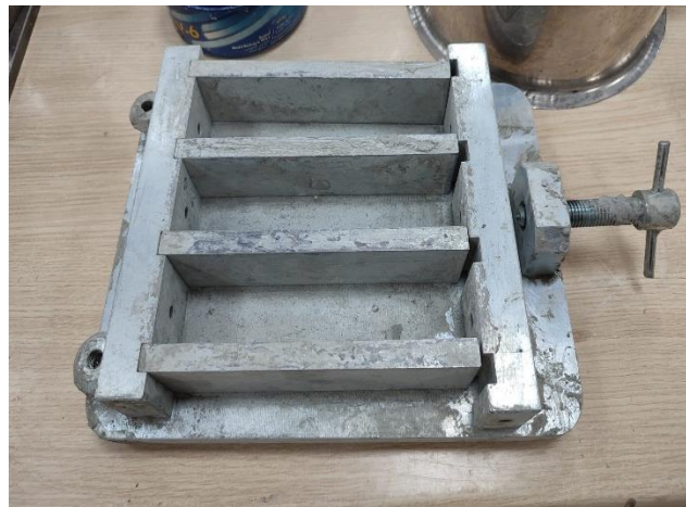
Şekil 3.5. Numune döküm için kullanılan 4x4x16 cm boyutlarındaki kalıp malzemesi
