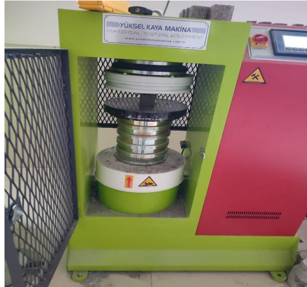
Şekil 3.13. Polimer beton numuneleri basınç dayanım testi ve deney cihazı
