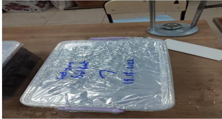
Şekil 3.2. Sodyum sülfat çözeltisine maruz bırakılan numunelerin muhafazası
