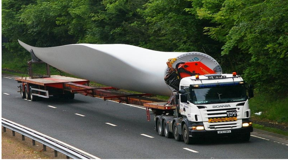
Şekil 1.13. Rüzgâr türbini parçalarının santral alanına taşınması (Url-13)
