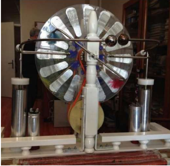
Şekil 2.1. (a) Wimshurst makinesi (Bekir Ege et al., 2014), (b) Van de Graaff generatörü (Lieberman, 2015)
