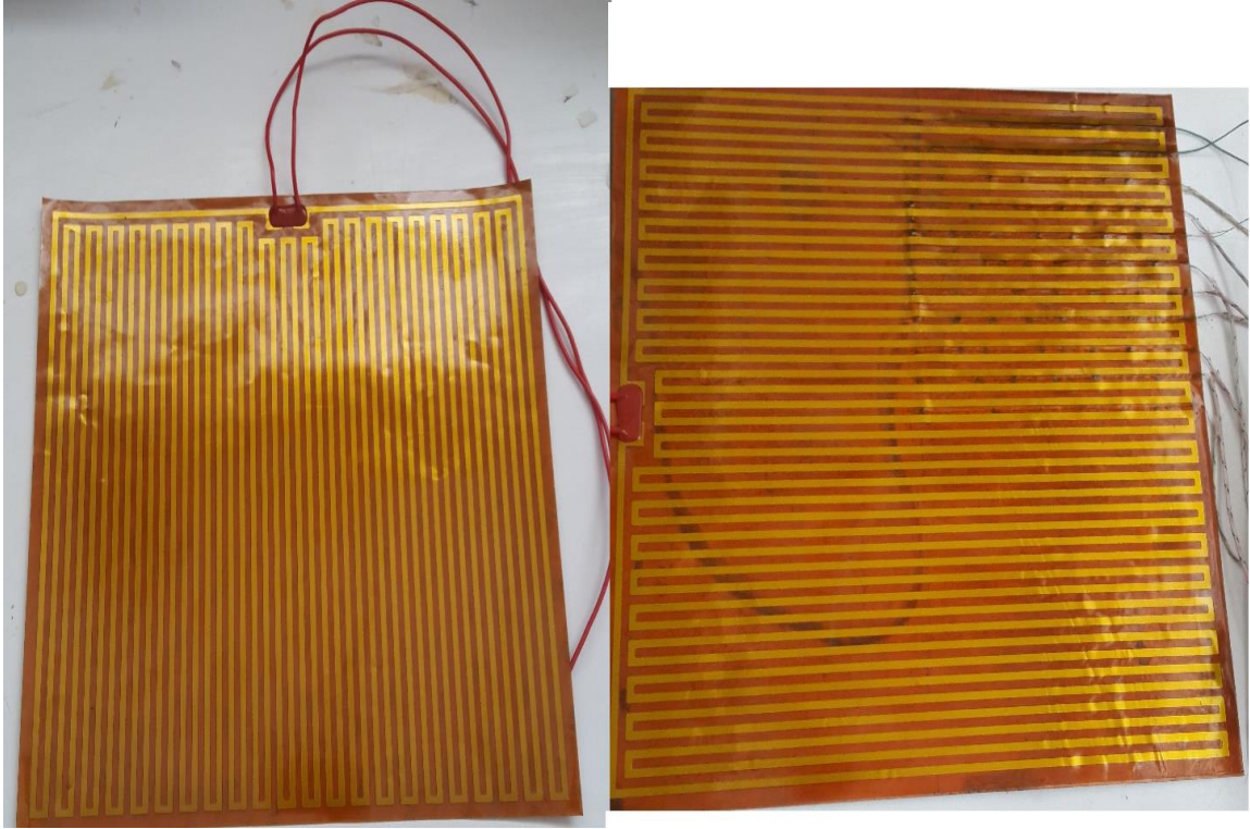
Şekil A3. Folyo tipi ısıtıcı ve termokulpların yerleştirilmesi
