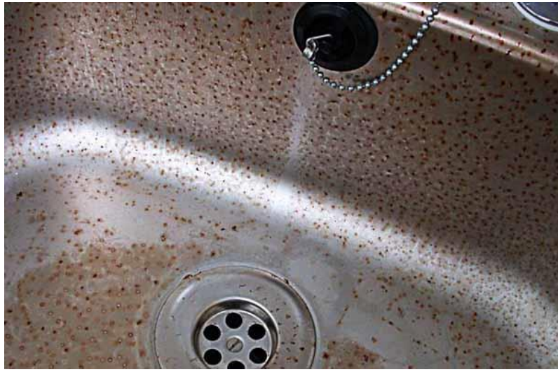
Şekil 1.4. Çukurcuk korozyonuna uğramış bir lavabo (URL-4 2017)
