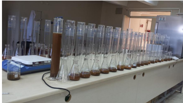
Şekil 3.5. Çalışma alanında alınan topraklarda karayolu uzaklıklarına göre tekstür analizi çalışması
