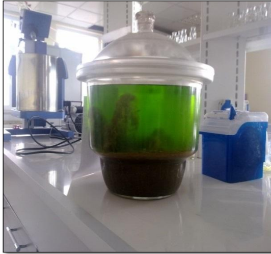
Şekil 4.1. P. ortegioides 'in toprak üstü kısımlarına uygulanan ekstraksiyon işlemi
