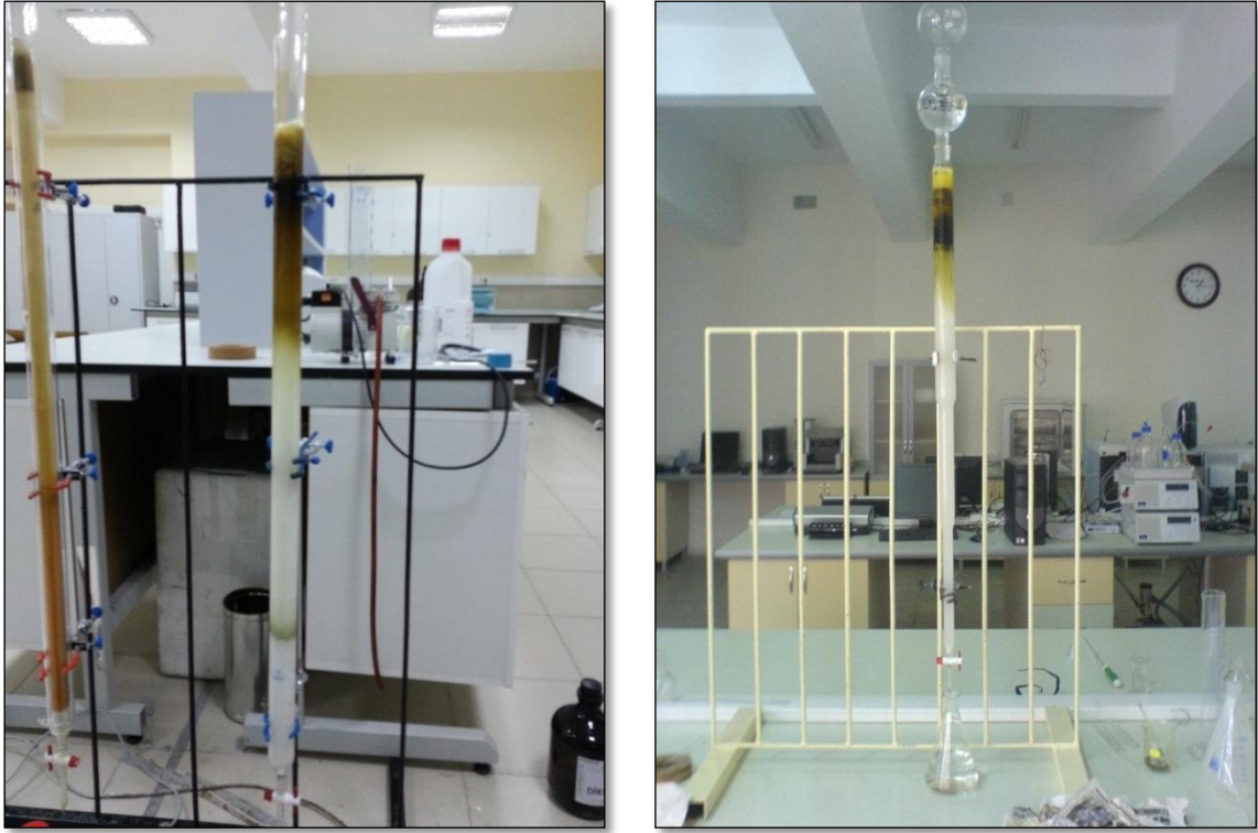
Şekil 4.7. İzolasyon işleminde kullanılan kolon kromatografi standları
