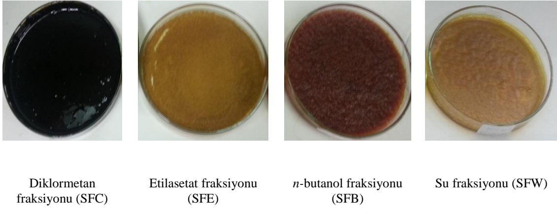
Şekil 4.3. Fraksiyonlandırma işlemi neticesinde elde edilen kuru fraksiyonlar
