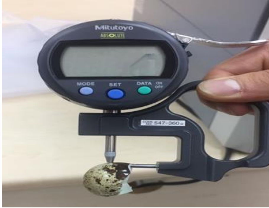
Şekil 3.3. Dijital mikrometre ile yumurta kabuk kalınlığının ölçümü
