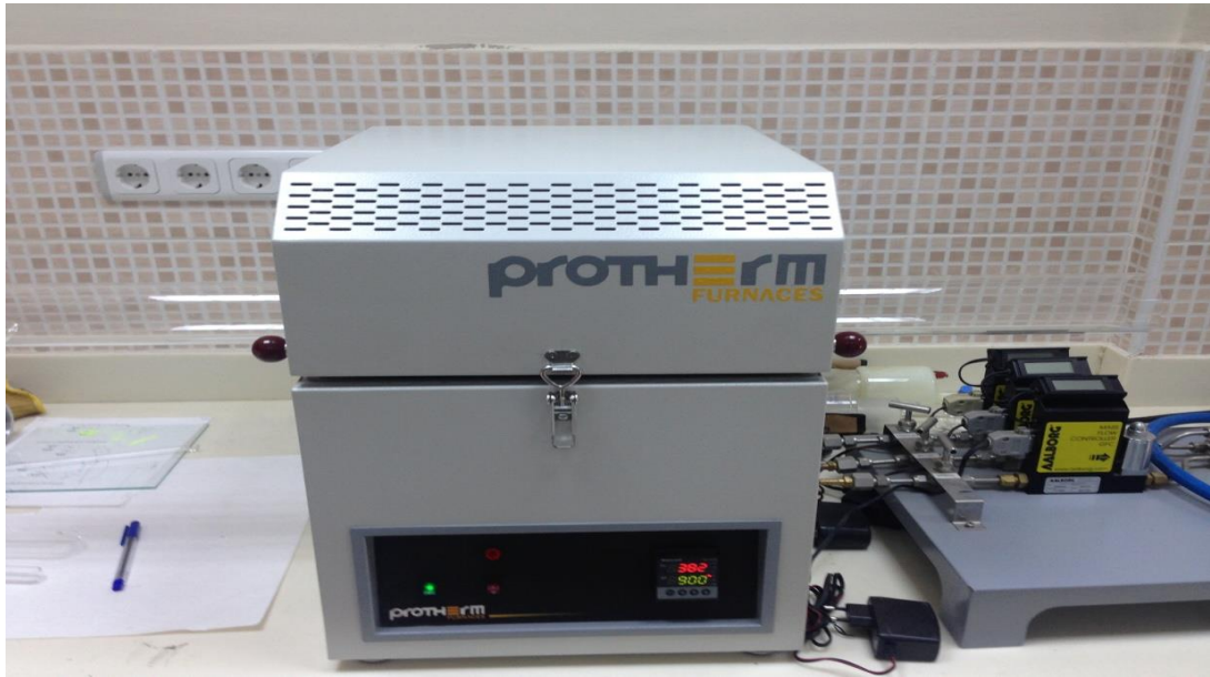
Şekil 4.2. Tavlama için kullanılan fırın
