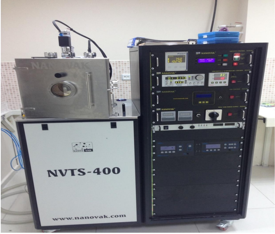
Şekil 4.1. Omik kontak işleminin gerçekleştiği cihaz
