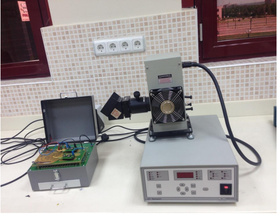
Şekil 4.4. Keithley 2400 sourcemeter ve güneş simülatörü
